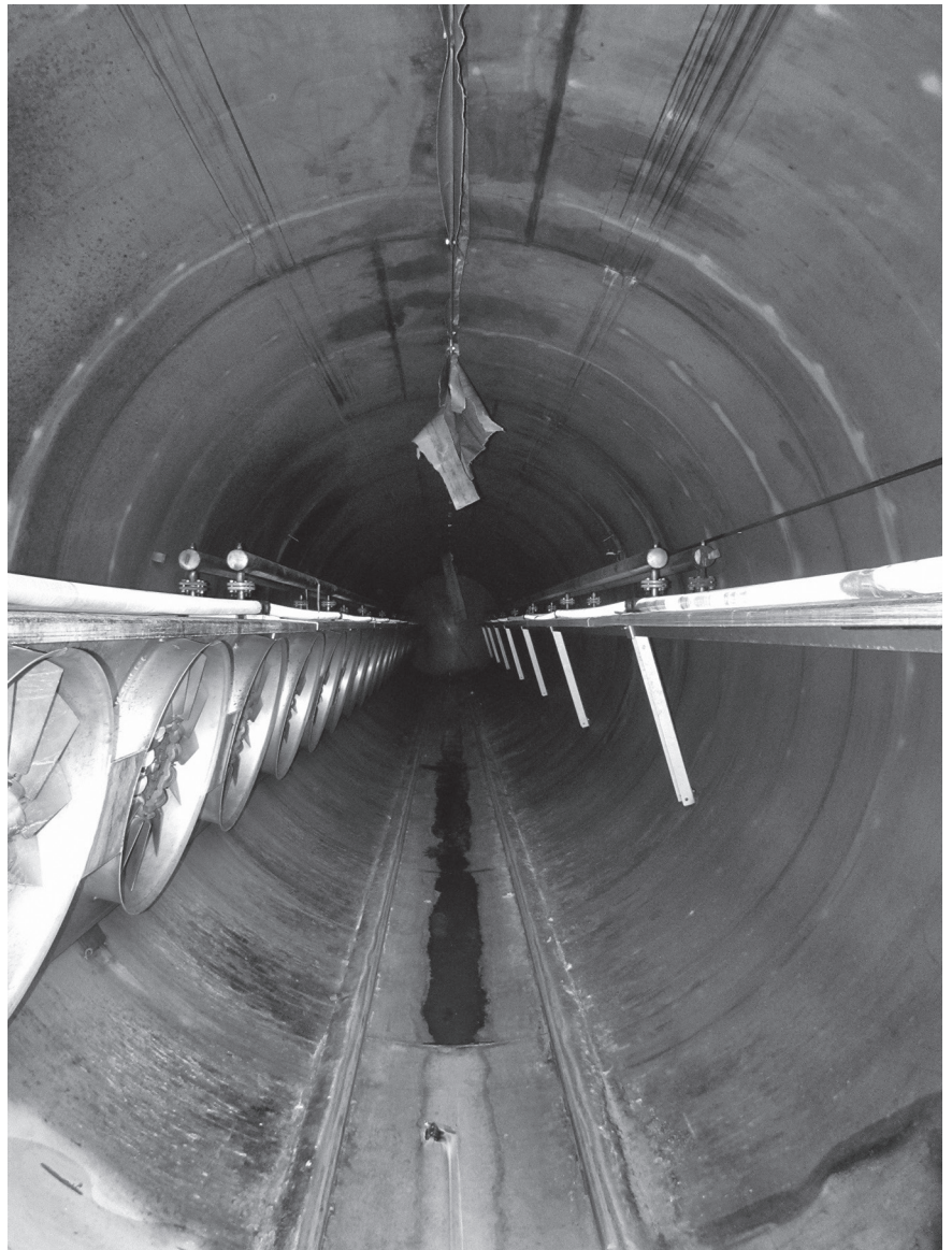
Afbeelding 41. Interieur van de vacuümdroger bij UVO Lopik. Links zijn de ventilatoren te zien. Foto: Innovita advies & projectbegeleiding
