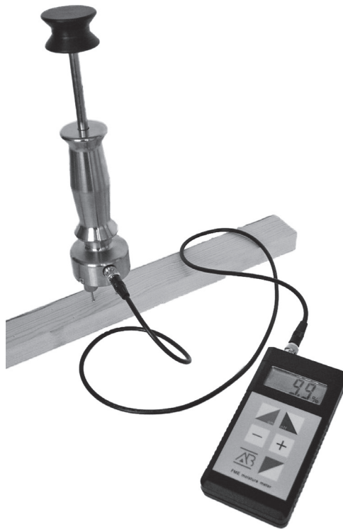
Afbeelding 24. Elektrische houtvochtmeter met zogeheten 'ram-elektroden'
