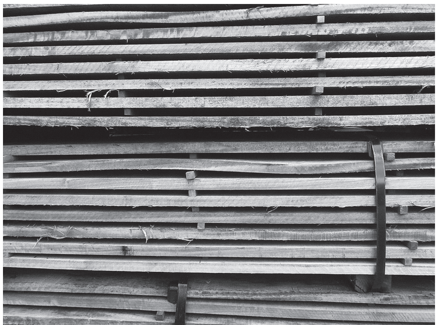
Afbeelding 17. Zichtbare vervorming in dun hout als gevolg van sterk wisselend draadverloop. Foto: Innovita advies & projectbegeleiding
