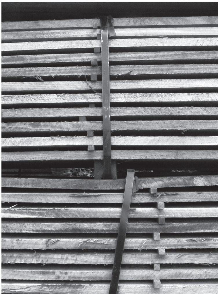
Afbeelding 21. Wanneer bij het stapelen van hout de latten en klossen niet exact onder elkaar liggen, ontstaat er 'gebogen' hout. Foto: Innovita advies & projectbegeleiding
