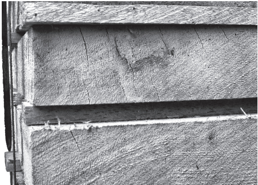
Afbeelding 30. Eindscheuren in niet-gedroogd hout dat in opslag staat. Foto: Innovita advies & projectbegeleiding
