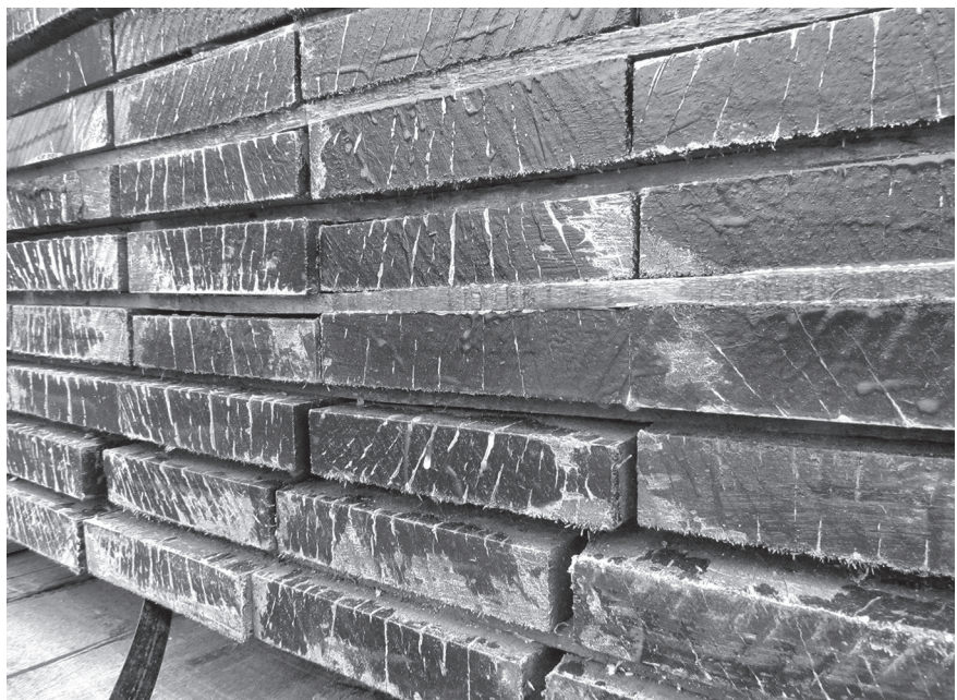
Afbeelding 31. Afdichten van de kopse kanten van hout om snelle waterafgifte via het kopse vlak tegen te gaan. Foto: Innovita advies & projectbegeleiding
