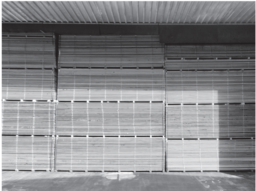
Afbeelding 19. Bundels hout in een conventionele droogkamer. Foto: Houtindustrie Schijndel
